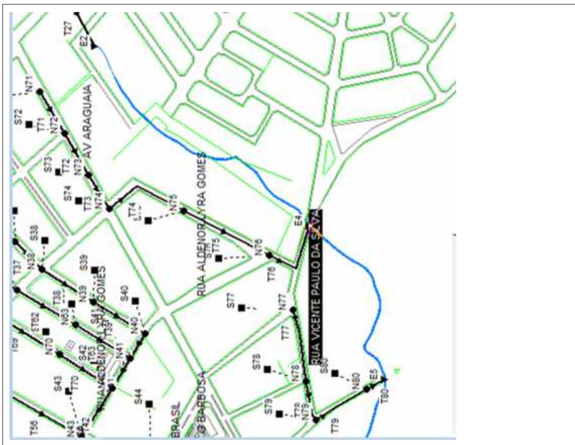
Figura 27 – Traçado parcial de duas redes de drenagem Araguaçu, que deságua nos exutórios E4 (começa em N71 e deságua em E4) e E5 (começa em N77 e deságua em E5)
