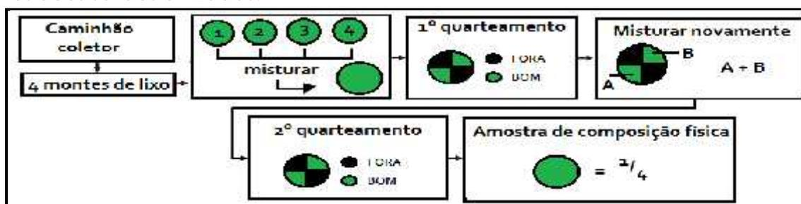
Figura 14. Metodologia de quarteamento utilizada para caracterização dos resíduos sólidos.
